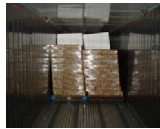
コンテナの中でラッシングや緩衝材が施されていない
