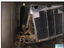
WINGトレーラーの中でラッシングが施されていない
